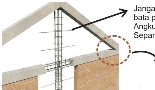
Jangan lupa untuk memasang angkur bata pada gunung - gunung. Angkur besi minimum 10 mm Sepanjang 40 cm, setiap 6 lapis bata
