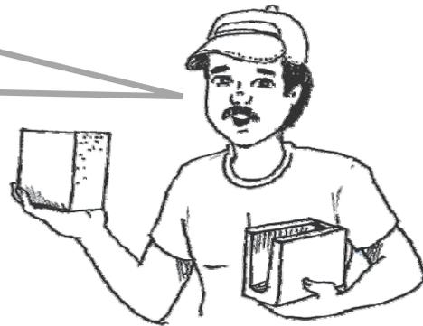
Tomando un bloque mitad, y con ayuda de una sierra, se le removerán ambos extremos tal como se muestra en la siguiente figura, permitiendo así el paso del refuerzo horizontal a través de él.
