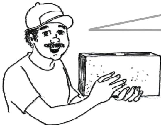
El bloque de concreto se compone de una mezcla de cuatro elementos: Chispa, arena, cemento y escoria volcánica.
