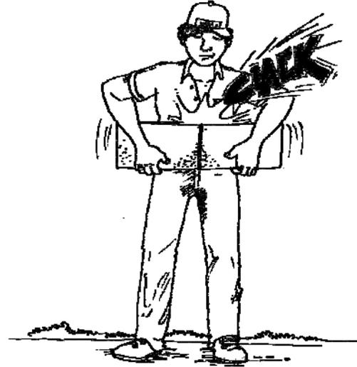
Apariencia del bloque: Si los defectos como grietas y astilladuras son visibles, o si se desmorona fácilmente de las esquinas, el bloque no posee la calidad necesaria para construir una vivienda.
