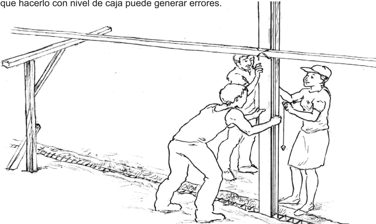
Al levantar las columnas, es necesario verificar con precisión que las distancias entre los postes, los niveles y la plomada sean exactas, porque de lo contrario habrá complicaciones en la colocación del Bloque Panel.
