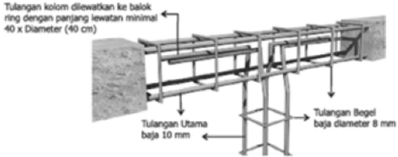
Gambar 48. Hubungan Anatar Kolom dengan Balok Keliling/ Ring
